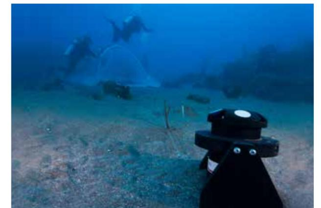
Signature500 ADCP 的中心波束也作为生物回声测深仪，从而能够以高分辨率来测量水中的生物量。
