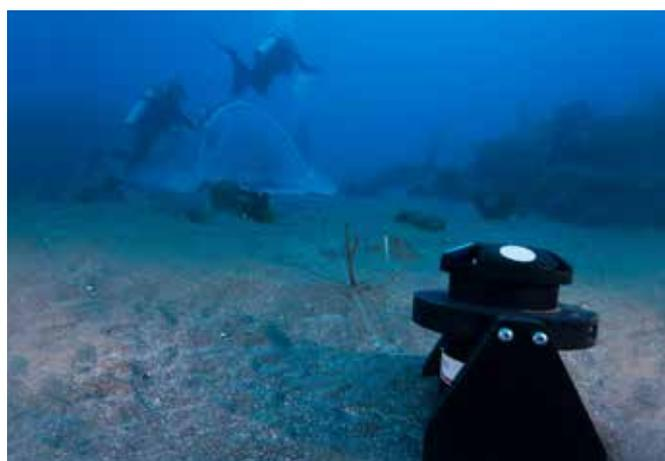
Signature500 ADCP 的中心波束也作为生物回声测深仪,从而能够以高分辨率来测量水中的生物量。
