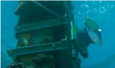
2D Horizontal Profiler是定点测量流速的理想工具, 比如, 安装在港口入口处的物理架构上。本声学多普勒流速剖面仪从安装点发出两个水平声束, 常用于实时监测海流数据至关重要的在线应用场景。
