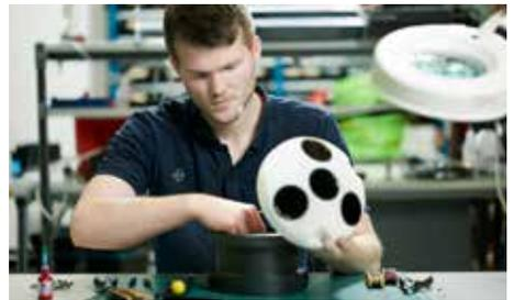
AWAC 1 MHz声学多普勒流速剖面仪已成为潜浮式波浪测量应用的标准技术。成千上万台此类ADCP, 已经投放使用, 结合海流剖面测量全波频谱。AWAC 1 MHz的最大波浪测量范围为35米, 表面高度采样频率高达4 Hz, 是浅水剖面海流和波浪测量的理想工具。
