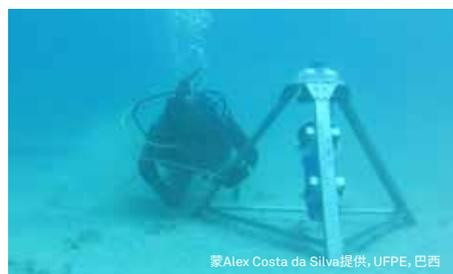
AWAC 600 kHz声学多普勒流速剖面仪已成为潜浮式波浪测量应用的标准技术。成千上万台声学多普勒流速剖面仪已投用, 结合海流剖面测量全波频谱。AWAC 600 kHz 最大波浪测量距离为60米, 采样频率为2 Hz, 是中等深度海流和波浪测量的理想工具。
