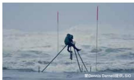
Vector是一种高精度单点流速仪,最高取样频率可达64Hz,可在极小样本条件下获取三维速度数据。它被广泛应用于沉积物迁移测量、小规模湍流测量和海岸线工程研究。在各种应用场景中,它均成绩显著,测量数据质量优异突出。本产品适用于不超过300米深的海洋测量作业。钛合金外壳的Vector适用于深海洋流。
