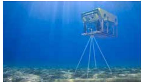
DVL1000是世界上最小的商用多普勒计程仪 (Doppler Velocity Log)。它设计紧凑小巧, 功能超前, 与同类产品相比, 在水体中既可以离底更远, 也可以更接近海床。它的最大作业深度达到4000米。在对设备大小和重量限制极高的海底勘探作业领域, 其实用性极强。1 MHz 多普勒计程仪因具准确度高、技术领先而深受深海作业的业界龙头青睐。
