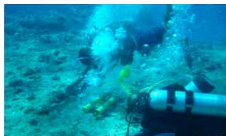
Aquadopp Profiler是一种用途很广的声学多普勒海流剖面仪(ADCP), 有从小于1米到大于85米共四种剖面量程可供选择。本流速仪操作简单, 功能强大, 拥有各种各样的功能, 工程师和研究人员利用这些功能在各种环境条件下开展准确而有效的水文动力学数据收集工作。
