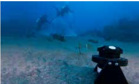
Signature500声学多普勒流速剖面仪应用灵活多变。它能以高达 8 Hz 的采样频率来测量海流剖面。同时它还可以直接测量垂向速度剖面、波高、波向以及冰层厚度和漂移速度。
