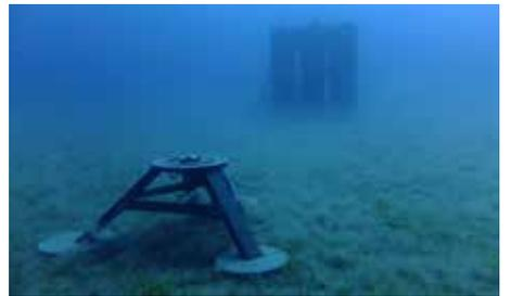
Signature1000声学多普勒流速剖面仪是湍流测量的理想工具。该款声学多普勒流速剖面仪的最大取样频率为16Hz,它为科技界提供了一个前所未有的机遇,使其能够研究之前无法研究的湍流谱部分。它能以2厘米的垂直海流剖面分辨率和长达8米的量程来进行测量,并且可对波高和波向测量,这些都进一步扩大了它的应用范围。它的中心声束也可以用作生物回声探测器(echo-sounder),可获取水体中高分辨率的生物量数据。
