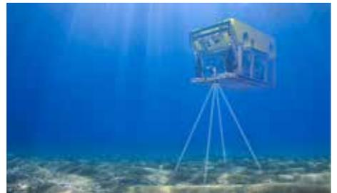
DVL1000は、市販品としては世界最小のドップラー速度ログ(DVL)です。コンパクトな設計と類を見ない機能性を兼ね備え、同種の機器よりも高高度かつ海底直近まで海底検知能力があります。最大水深4000 mまで運用可能であり、サイズと重量が重視される海底航行での使用に最適です。この1 MHzドップラー速度ログは、高い精度と最先端技術が認められ、海底市場をリードするメーカーを始め、多く採用されております。
