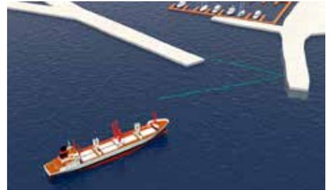
2D Horizontal Profilerは、港口などの構造物からの流向流速測定に理想的なツールです。このADCPにより、設置地点から2方向の平面流向流速プロファイルが得られます。流速データへの即時アクセスが最重要となるようなオンライン用途で広く使用されています。
