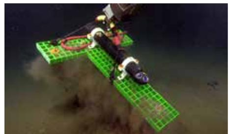
Aquadopp標準モデルの持つ機能と性能すべてを搭載したAquadopp 3000 m 流速計は、世界中の海洋研究者によって20年近く使用され、性能が実証されてきました。過酷な環境に耐える革新的なデータ診断機能によって、非常に高品質な三次元流速測定が可能です。また、様々な仕様の係留索や、プラットフォーム底部もしくはその側面に対し、容易に取り付けを行える構造となっております。
