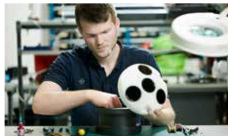
AWAC 1 MHz ADCP は、水中での波浪観測用途において標準の参照技術となりました。数千台ものこれらの ADCP が、流向流速プロファイルに加え、広周波数波浪スペクトルの把握に使用されています。波浪の検知距離は最大 35 m、海面変動のサンプリング周波数が 4 Hz である AWAC 1 MHz は、浅海における流れと波浪の測定に最適なツールです。
