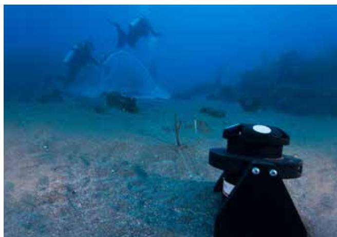
Signature500 ADCPのセンタービームはエコーサウンダー機能を搭載でき、水柱内のバイオマスを高解像度で測定が可能となります。
