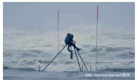
Vectorは最大64 Hzのサンプリング周波数の設定、非常に小さなサンプリング体積での三次元流速測定が可能な高精度シングルポイント流速計です。堆積物移動、微小スケールの乱流測定、海岸工学研究等の用途に幅広く使用されています。多様な用途で優れたデータ品質を提供してきた実績があります。本モデルは、水深300 mまでの使用に適しています。Vectorチタン仕様モデルは、深海域での流向流速測定に適しています。
