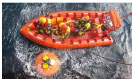
Signature55 ADCPは、長距離計測レンジを持ちながらコンパクトなレイアウトを両立した最新の流向流速プロファイラーです。新設計のADCPトランスデューサーにより、一台の機器で2種類の周波数を使用できます。測定距離1000 mの流向流速プロファイリングを行いながら、やや短い距離での高解像度な流向流速測定を行うことができます。(同種のADCPと比較して)消費電力を90%以上削減することによって、内蔵バッテリー駆動による長期間観測が可能です。
